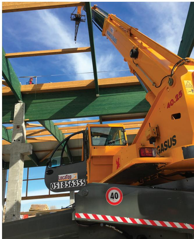
I sollevatori telescopici fissi sono macchinari pensati per essere di supporto alla movimentazione di materiali pesanti in cantiere, possono infatti essere impiegati come una sorta di piccola autogru, più compatta e versatile ed in grado di supportare pesi elevati senza essere di alcun rischio per il personale addetto.
