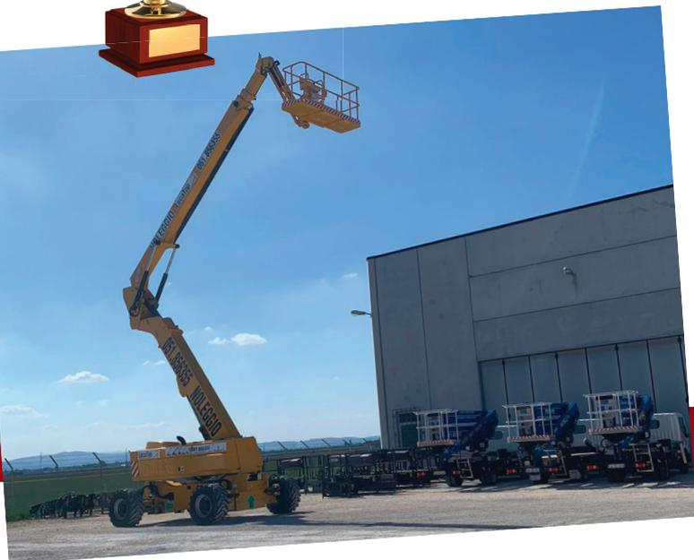
La piattaforma Haulotte HA 32 PX è una piattaforma articolata semovente diesel. Questo particolare modello ha un'area di lavoro senza limitazioni con uno sbraccio massimo di 21.60 metri, è polivalente, ha una capacità di movimento fuoristrada grazie alle quattro ruote motrici abbinata all'assale oscillante e possiede un tempo di sviluppo ineguagliabile di 95 secondi grazie ai comandi completamente proporzionali e simultanei. Questa piattaforma è ideale per lavori all'esterno.
